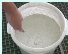
2. Réaction coagulante, la peinture est séparée de l'eau
