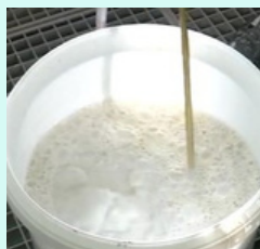
1. Agitation des eaux souillées avec le Floculant
